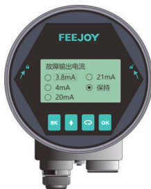
图6-20 故障输出电流编辑界面
