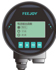
图6-16电流输出函数编辑界面
