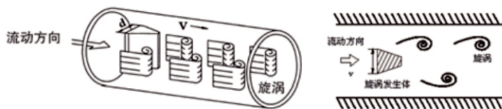
图1-1 涡街流量计工作原理示意图
